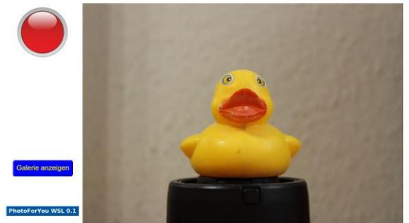
Nachdem der Auslösebutton betätigt wurde, wird rechts oben ein animierter Countdown angezeigt, der von 5 bis 0 herunterzählt. Das Livebild bleibt während des Countdowns aktiv. Nach ca. 6 bis 8 Sekunden löst die Kamera aus, was auch davon abhängt, wie lange die Kamera zum Fokussieren benötigt. Die Buttons in der linken Spalte sind während des Countdowns deaktiviert, um Fehlbedienungen zu verhindern!
